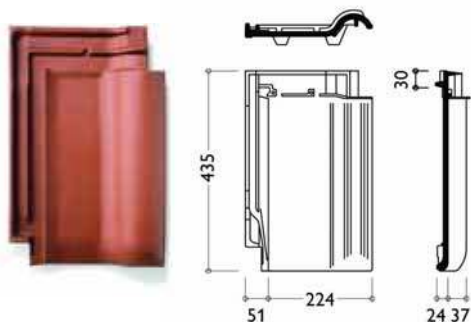
Рис.5. План черепицы, поперечный и продольный разрезы. Рекомендуемый уклон кровли – от 22°; Вес черепицы ~ 3,2 кг.; Расход на 1 м 2 ~ 12,9 шт.; Средняя длина черепицы в кровле ~330- 360 мм (см. рис. 6); Средняя ширина черепицы в кровле ~ 224 мм (см. рис. 7);
