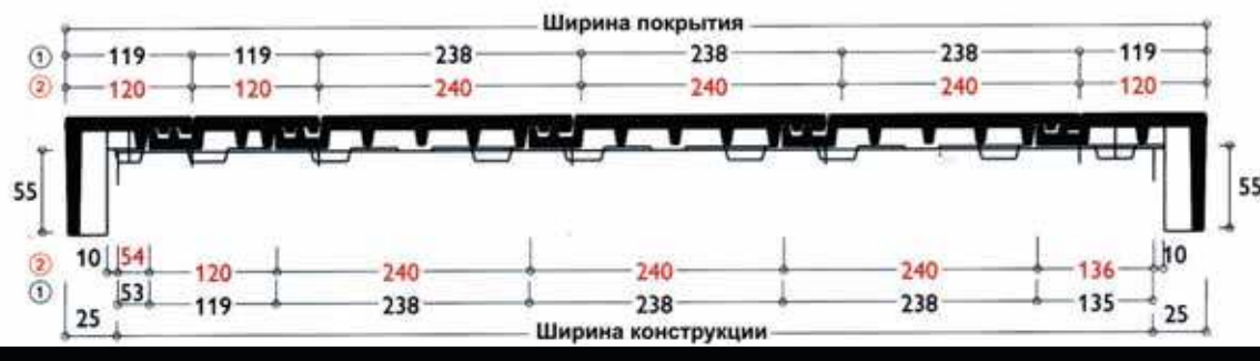
Рис. 28. Продольный разрез кровли с применением на фронте боковой черепицы (левой и правой).
