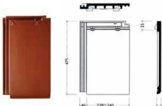
Рис. 26. План черепицы, поперечный и продольный разрезы. Рекомендуемый уклон – от 30 град.; Вес черепицы – 4,4 кг; Расход на один на 1 кв. м – 11,1 шт.; Средняя длина черепицы в кровле – 370 мм (см.рис. 27) Средняя ширина черепицы в кровле – 205 мм (см. рис. 28)
